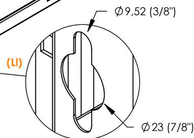
Perforaciones tipo "llave" dobles (LI) para montaje en pared.
