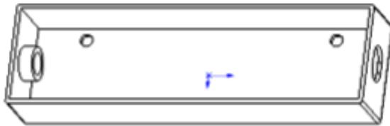
Estructura soporte de Acero para el acumulador de rack RLB10048
