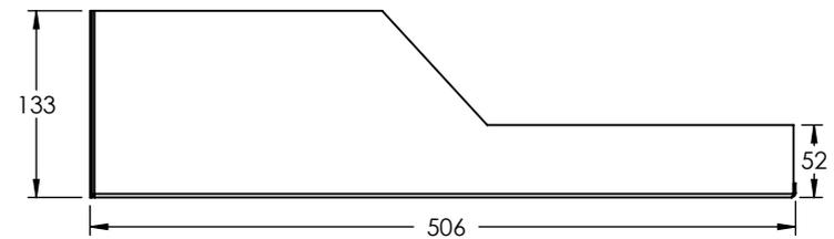
1. Fabricado en lámina de acero rolado en frío calibre 16.
