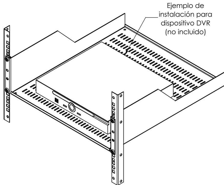
1. Fabricado en lámina de acero rolado en frío calibre 16.
