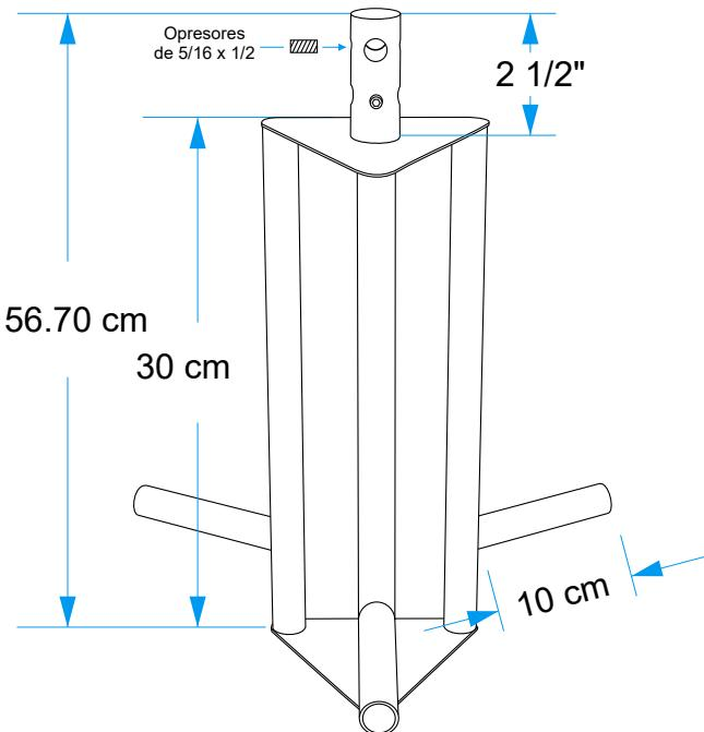
Fabricado en acero inoxidable electrosoldado, con terminación en forma de delta estrella para garantizar el punto de menor resistencia y una mayor área de contacto con el terreno.
