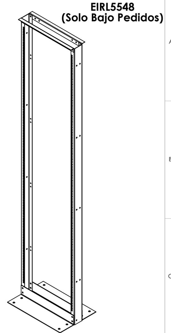
1. Fabricado con lámina de acero rolado en caliente calibre 11 y 14.
