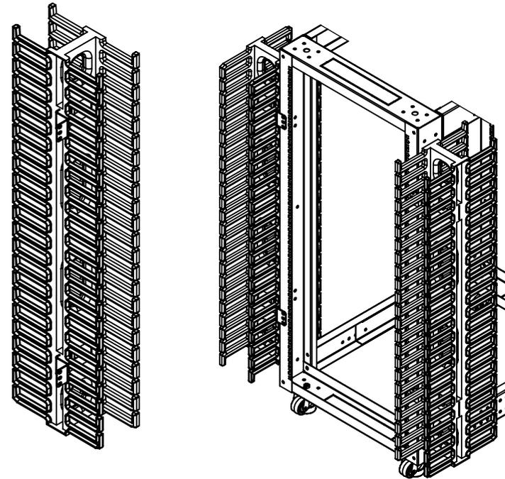
1. Fabricado en lámina de acero rolado en frío calibre 16.
