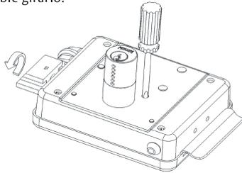
• Funcionamiento (Apertura y Cerrado): Conectar los cables a corriente directa de 8V - 12V, apretar el botón, la cerradura debe abrir. Para evitar que la cerradura sea abierta con el botón por el interior, girar la llave 360° en sentido de las manecillas del reloj con la finalidad de bloquearlo.
